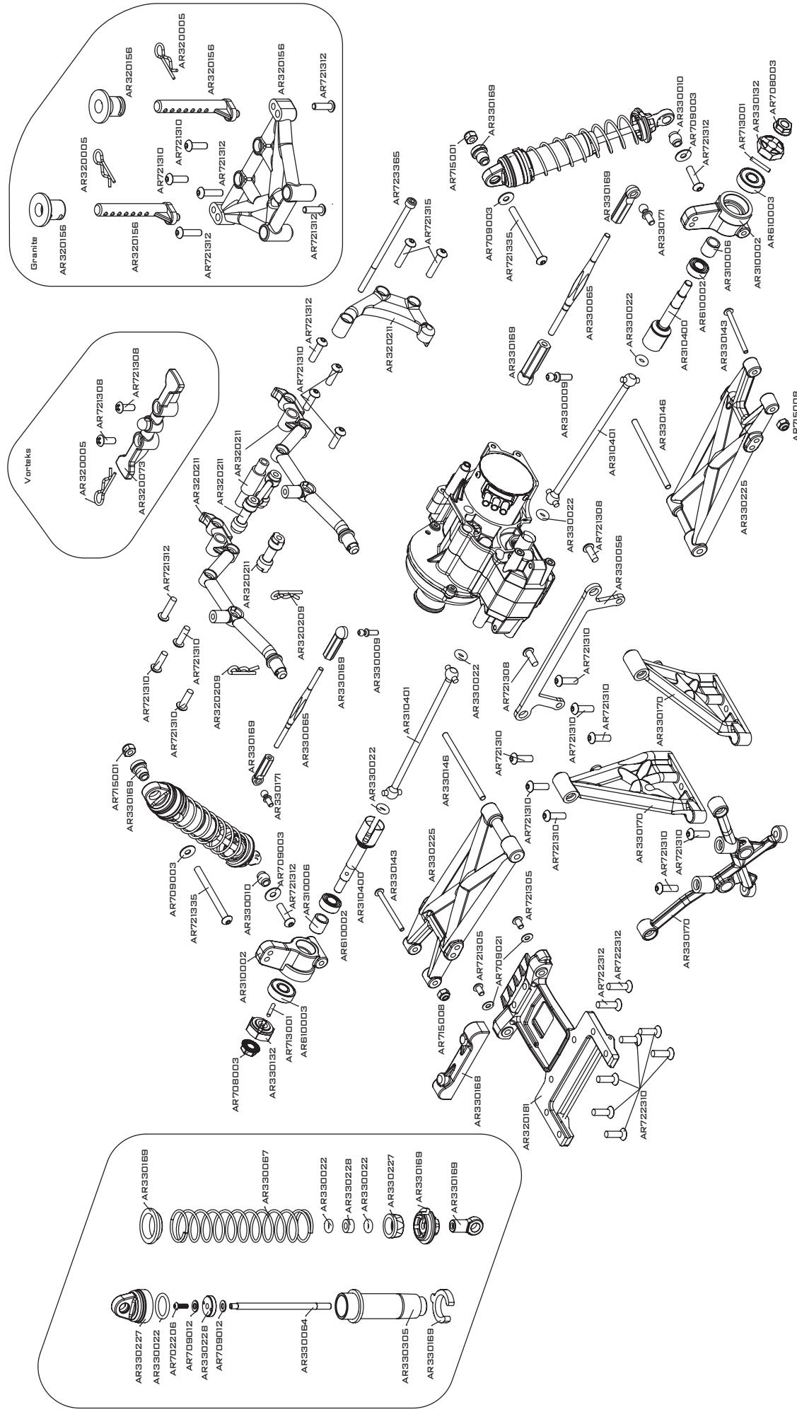
Gearbox Getriebe Boîte de vitesses Caja de cambios ギアボックス 齿轮箱
